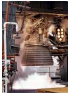
J-2发动机是一款液态燃料低温火箭发动机，曾被用于NASA的土星1B号运载火箭和土星5号运载火箭。J-2发动机由Rocketdyne在美国制造，以低温液氢和液氧为推进剂，每台发动机在真空中能产生1,033.1 kN推力。发动机最初的设计可以追溯到1959年Silverstein委员会的建议。[维基百科](#)
